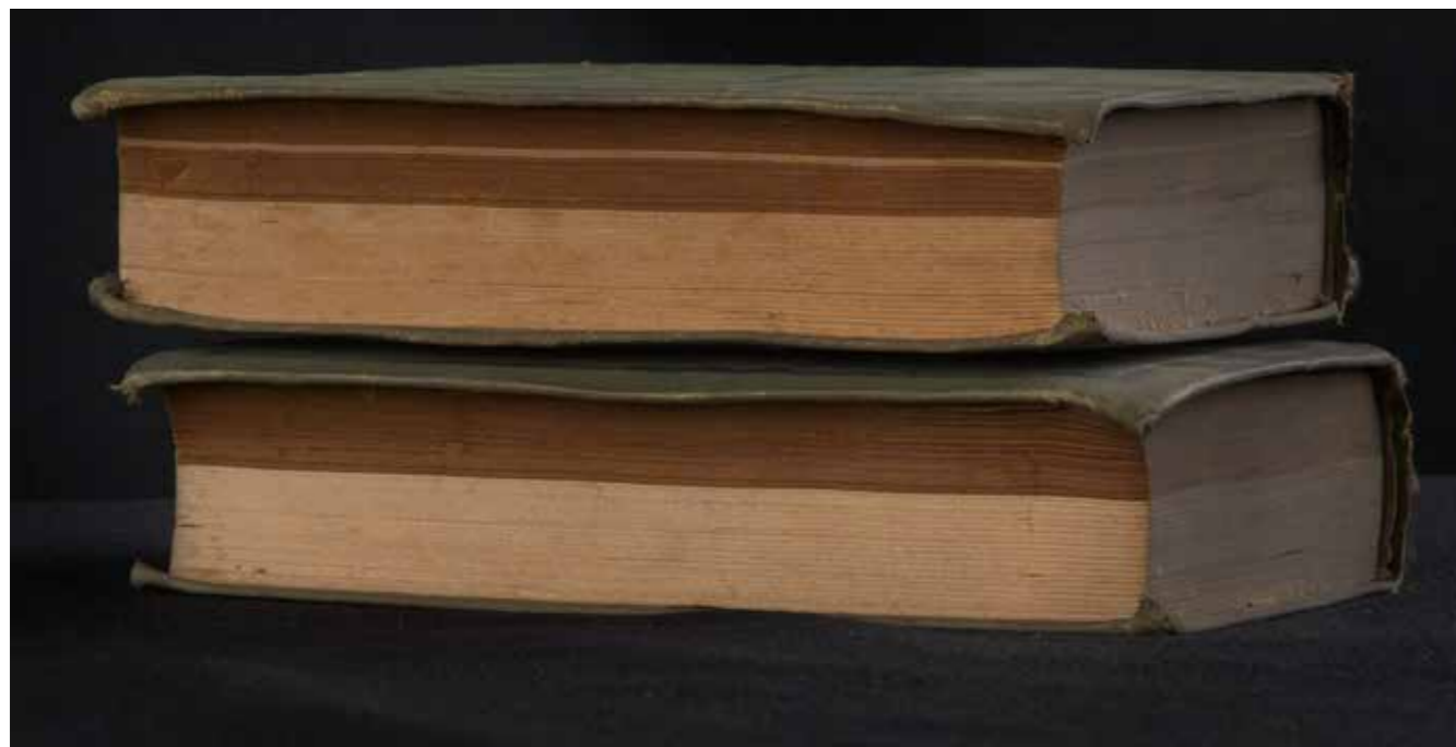
► Libros elaborados con dos tipos de papel, uno de peor calidad, que ha reaccionado de forma muy diferente a los agentes atmosféricos (luz, temperatura y humedad), oscureciéndose y haciéndose más quebradizo.
